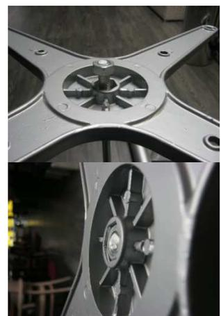
3. Fixieren Sie das Kreuz indem Sie von unten eine Mutter entsprechend kontern. (Bitte zwischen Kreuz und Mutter eine U-Scheibe und ein Federring legen)
